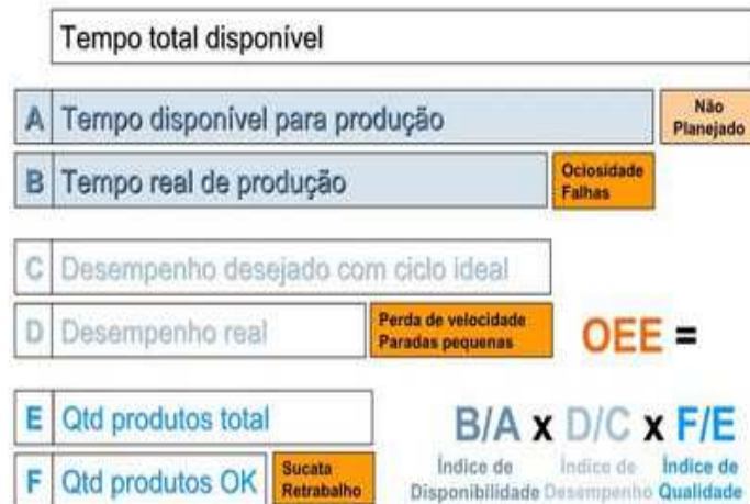
Figura 2: Elementos da eficácia global de um equipamento.
